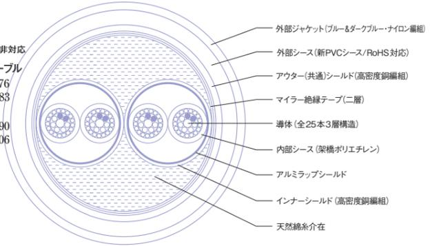
●導体構成：超高純度7NクラスCu、高純度無酸素銅線PCUHD、純銀コートOFC、高純度無酸素銅OFC
