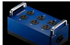
■筐体：アルミダイキャスト ●配線材：超高純度7NクラスCu、高純度5NCu、純銀コートOFC、高純度無酸素銅OFCの4種をハイブリッドした3.5スケアの導體を採用 ●インレット：3Pタイプ（ロジウムメッキ） ●アウトレット：3Pタイプ2口（ロジウムメッキ）×3個（合計6口） ●許容電流値：15A（125V） ●サイズ：220mm（W）×120mm（D）×110mm（H） ●重量：3.3kg ●電源ケーブルは付属しておりません。 ※内部配線は配線の都合上、筐体のインレット側から見て一番近いコンセント（アウトレット）へまず接続され、手前に向かって直列に接続されています。
